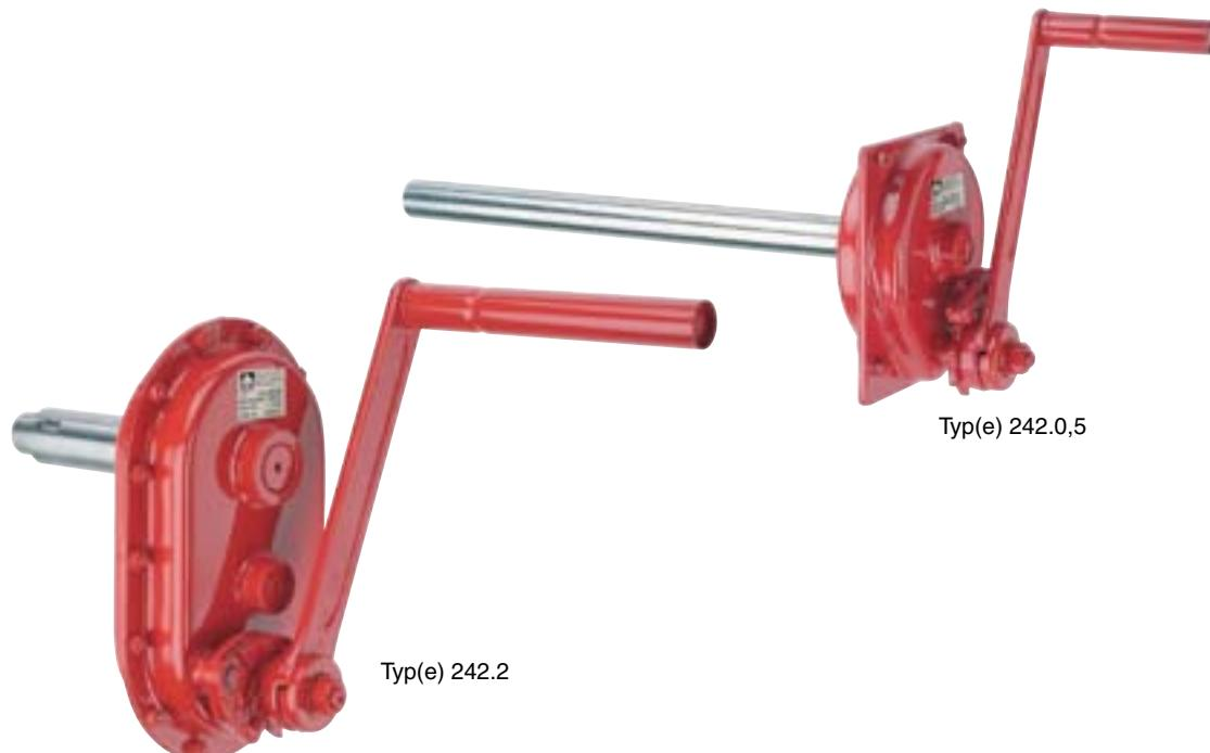
**Universell einsetzbare Getriebe für Handantrieb. Motorischer Antrieb bei einer Eingangsrehzahl bis 100 U/Min. im Kurzzeitbetrieb möglich.**
